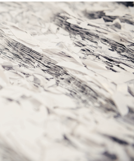
Ritagli della produzione di carta reintrodotti nel processo di produzione (PRE-cw)
